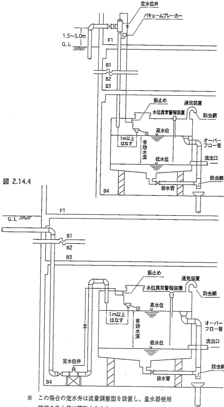
※ この場合の定水位弁は流量調整型を設置し、量水器使用範囲の最大値に調整すること
